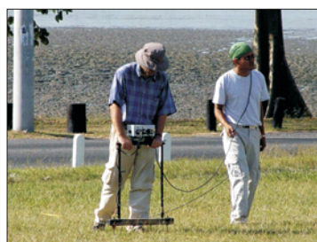
Geoelektrische Kartierung für Archäologie
