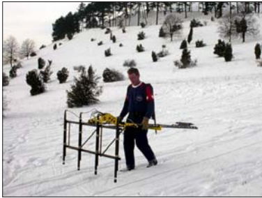
Das FEREX 4-Kanal-Gradiometer im Einsatz. Vermessung hallstattzeitlicher Siedlungsspuren am Ipf
