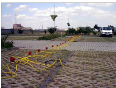
Geoelektrische Tomographie auf versiegelter Fläche
