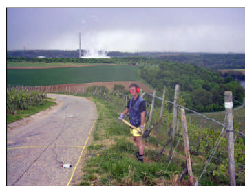
Refraktionsseismik zur Trassenvorerkundung
