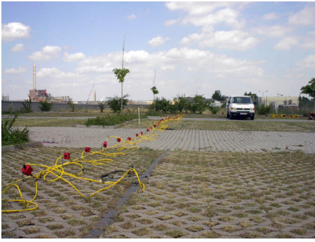
Geoelektrische Tomographie im Einsatz
